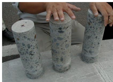
写真-2 コア採取した供試体
