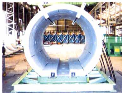
図-1 セグメント仮組立全景
