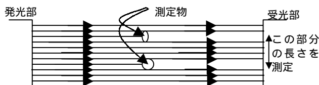
図4 レーザーによる開口変位測定の概要
