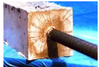
写真 - 1 ひび割れ発生状況 (ECC)
