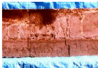
a) 普通コンクリート補修供試体
