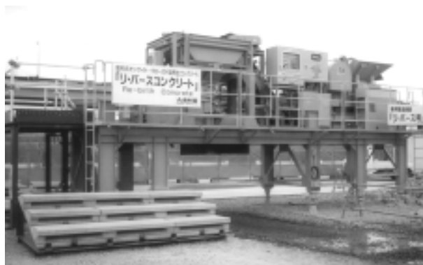
写真1 階段ブロックと専用製造装置
