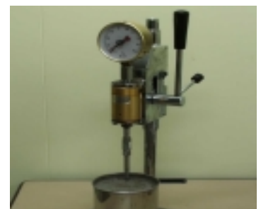
写真-1 貫入抵抗試験
