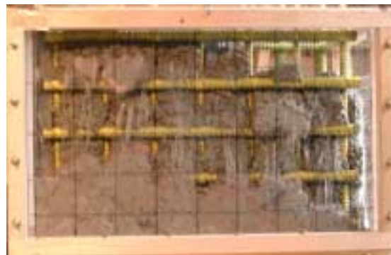
写真 - 2 コンクリート充填状況 (配筋 H32V19)
