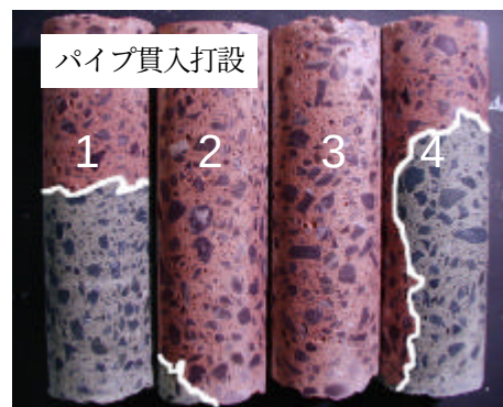
写真-1 内部流動状態の観察 (打重ね時間間隔: 50分)
