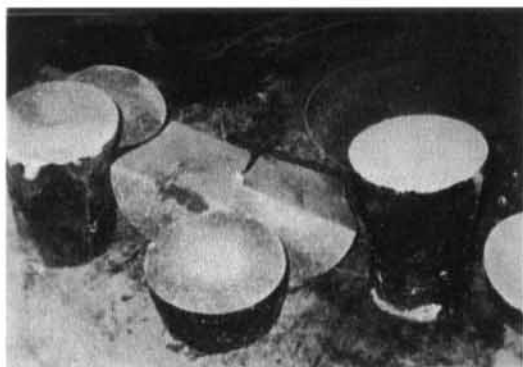
写真-2 充填モルタル切断後(付着無し)
