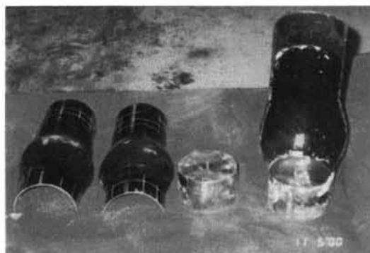
写真-1 充填鋼管切断後(付着無し)
