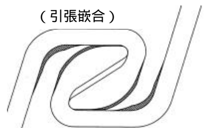
図 - 1 遮水材塗布状況 ( 膨潤前 )
