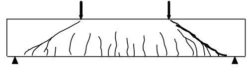
図-3 試験体3のひび割れ状況
