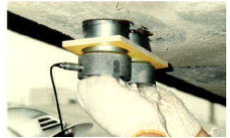
写真-3 探触子の設置状況
