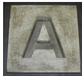
図-3 内部空隙供試体の外観(裏面)
