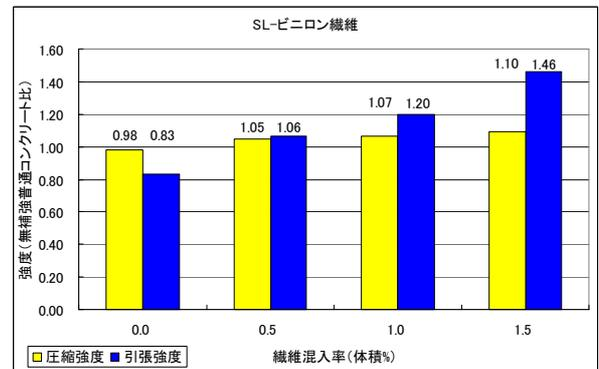
図 - 2: SL - ピニロン短繊維の圧縮, 引張強度
