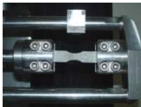
写真-1 供試体設置状況（SEM内部）
