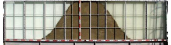
写真1 大型二次元水槽による流動実験
