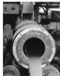
写真1 スラッジの 排出状況
