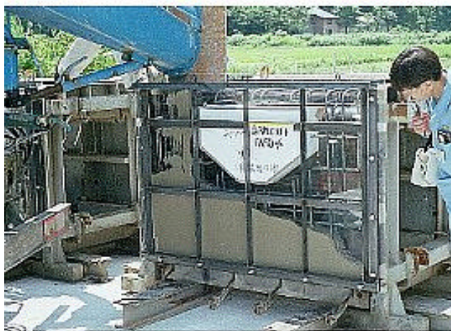
写真 - 1 高流動コンクリートの充てん性
