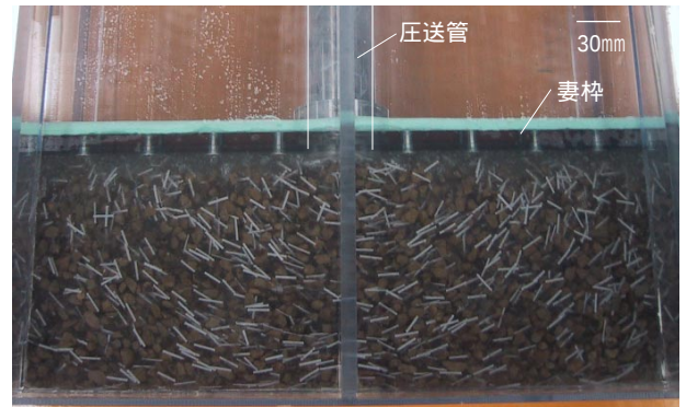
図—4 ECLモデル型枠内へのSFRCの充てん状況例
