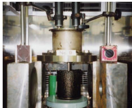
写真 - 1 変形特性試験
