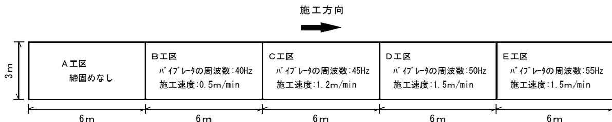
図-1 実験ヤード工区割付け図
