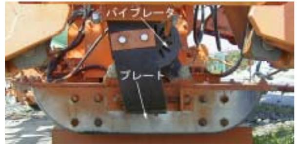
写真-1 締固め機械プレート部
