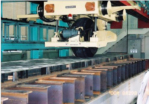
図-3 移動載荷試験の状況
