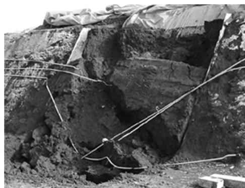
写真-1 試験盛土(崩壊試験中)
