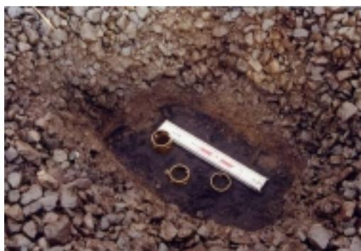
写真 - 6 不攪乱試料のサンプリング
