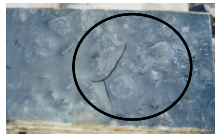
図4 加硫ゴム（溝）の試験終了後の破損状況
