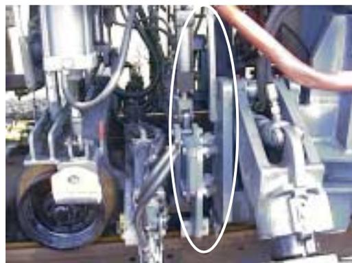
図 - 2 ライニングユニットに軌間修正装置取付図
