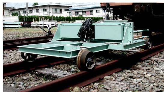
図3 試作した軌道検測装置
