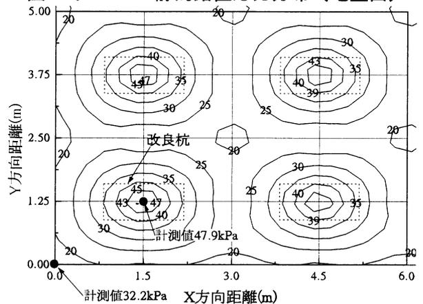
図 4 ケース 2 静的鉛直応力分布（地盤面）
