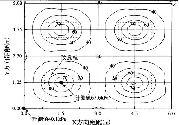
図 3 ケース 1 静的鉛直応力分布（地盤面）
