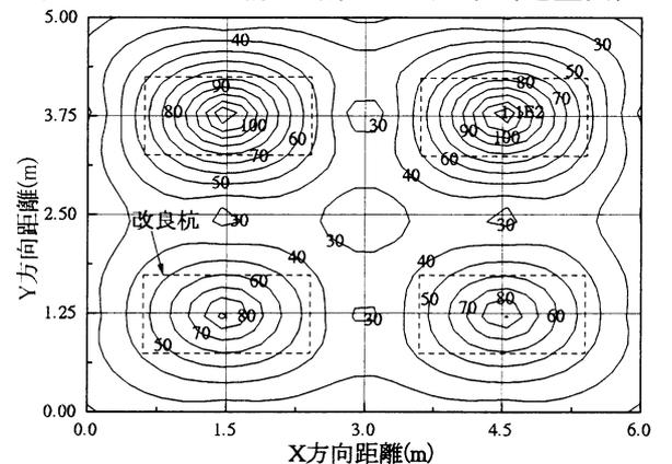
図 5 ケース 3 静的鉛直応力分布（地盤面）
