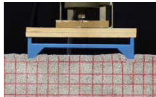
写真-2 布基礎の模型
