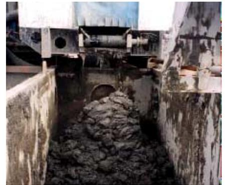
写真1 遠心分離機により分離された二次処理土
