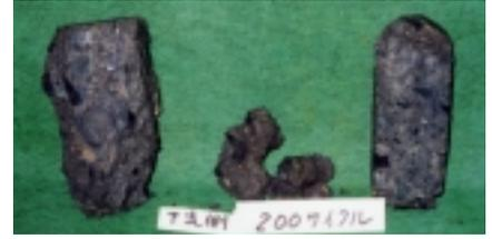
写真-1 B 供試体の試験前後の変化
