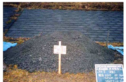
写真-2 改良土(固化材+古紙+ポリマー)
