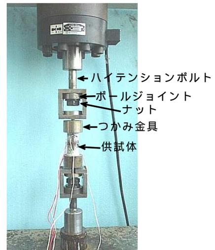
図1 一軸引張試験の外観
