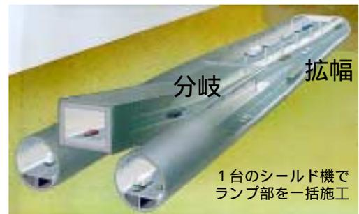
図-1 オクトパス工法概要図
