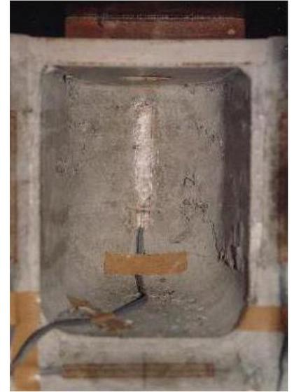
次に、継ぎ手ボックス上 $10 \times 10\text{cm}$ の範囲に載荷した(JC-2)結果、 $1660\text{kN}$  ( $166\text{N/mm}^2$ )で最大ひずみが $5000\ \mu$ となって、破壊した。破壊状況を図-3に示す。破壊強度は、コンクリート円柱供試体圧縮強度 $69.5\text{N/mm}^2$ の2.4倍となり、破壊ひずみも2倍となった。直線部用セグメントでも、曲線部施工時のジャッキ推力に対しては安全であると考えられる。
