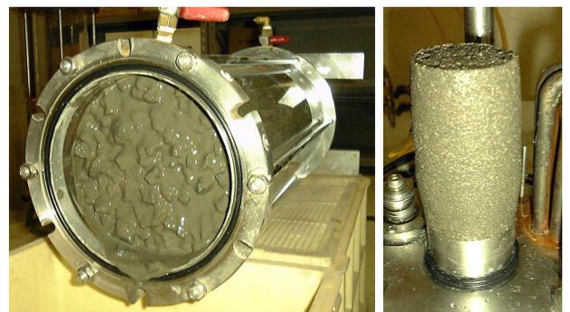
写真-1. 浸透実験後の模擬砂礫地盤が自立している状況
