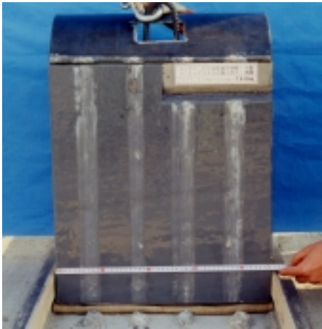
写真ー1 試験後の防水層の状態(養生1日、厚さ3mm、750kg)
