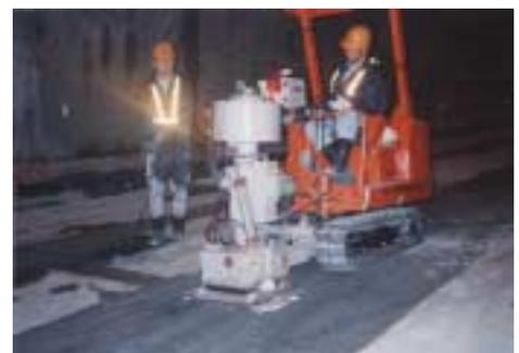
図1 油圧インパクト起振状況
