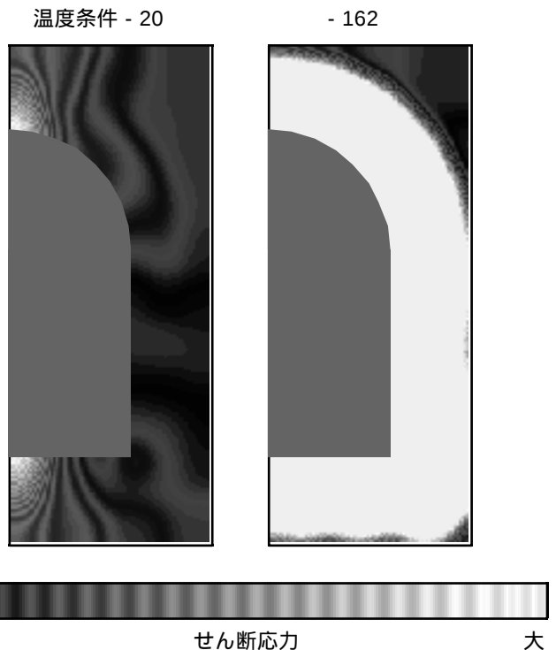
図-6 凍結開始から750分後の空洞周辺のせん断応力分布
