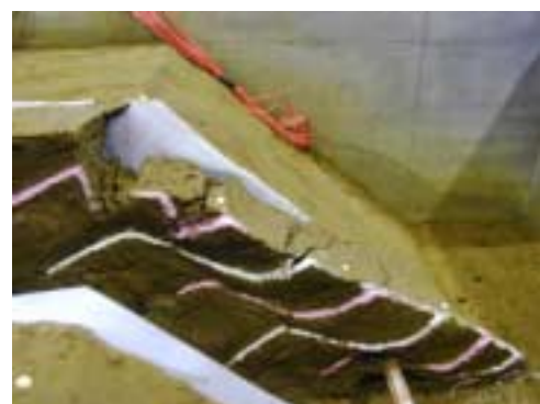
写真-4 傾斜地盤の崩壊断面(CASE-3)
