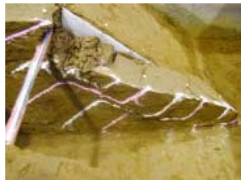
写真-2 傾斜地盤の崩壊断面(CASE-1)
