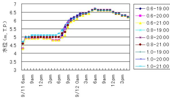
図4 推定された湛水位の時間変化
