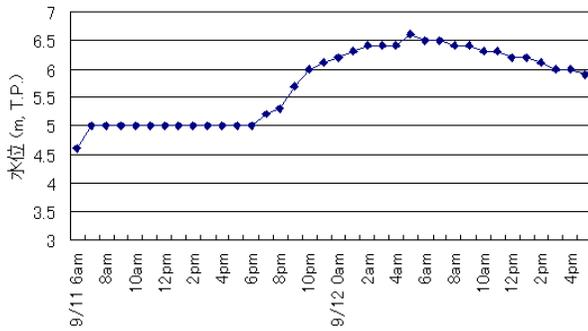
図5 排水ポンプが停止しなかった場合の浸水位変化
