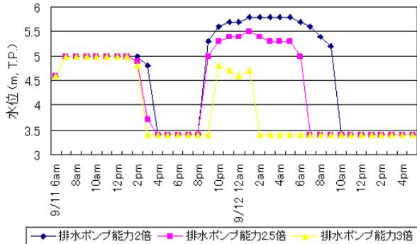
図6 排水ポンプ能力を増強した場合の浸水位変化
