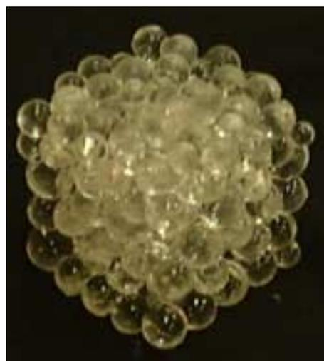
写真-1 真球透明体の多孔ブロック
