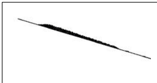
図1 一様斜面上の土石粒子の堆積形状
