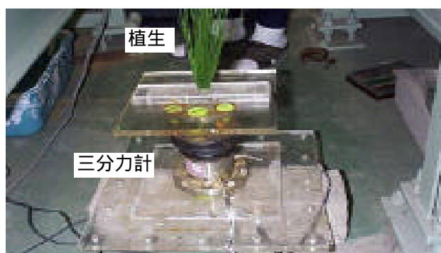
写真-1 植生模型および三分力計
