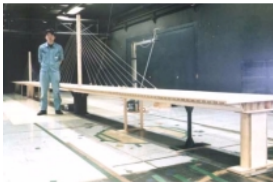
写真-1 3次元弾性模型(縮尺 1/37)
