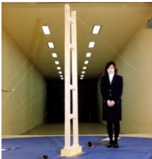
図2 風洞試験実施状況(模型縮尺1/50)
