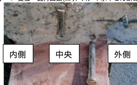
写真 - 1 スタッドタイプ溶接部の破壊状況
