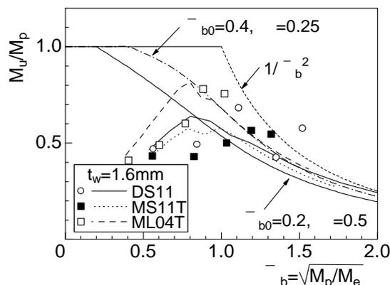
図3(c) 座屈耐荷力曲線 ( $h/t_w=180, t_w=1.6mm$ )
