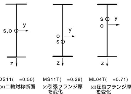
図 1 フランジ厚を変化させた断面形
