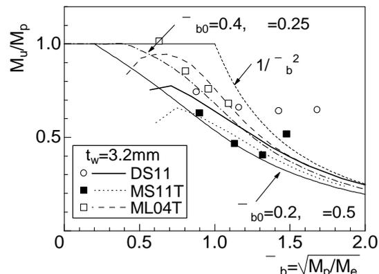
図3(a) 座屈耐荷力曲線 ( $h/t_w=90, t_w=3.2mm$ )
