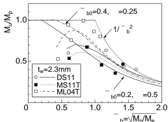
図3(b) 座屈耐荷力曲線 ( $h/t_w=125, t_w=2.3mm$ )
