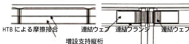
図-4 増設支持縦桁工法
