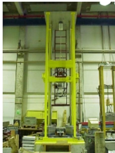
写真-1 大型衝撃実験装置
